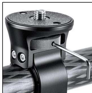
雲台取付ネジは3/8インチ(太ネジ)を採用。六角レンチによる締め込み機構と併せて、撮影機材を確実に固定します。台座部分の直径は55mmと、大型雲台やノートPCトレイと組み合わせても安定した設営が可能です。回転防止機構を持ち、誤ってセンターポール上で回転することはありません。
